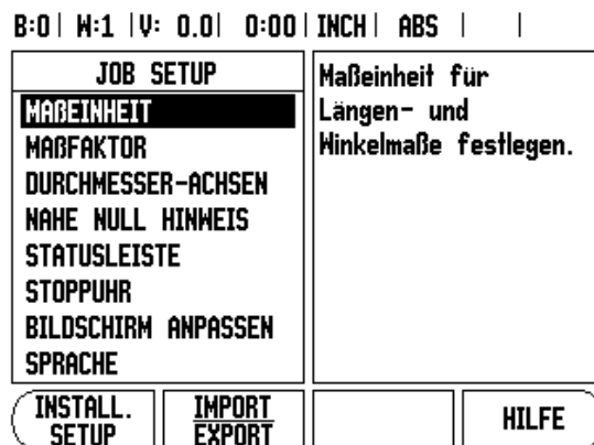
Abb. I.3 Menü JOB SETUP für die Anwendung Fräsen
