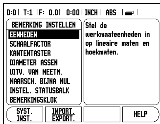
Fig. I.3 Het scherm BEWERKING INSTELLEN tijdens frezen
