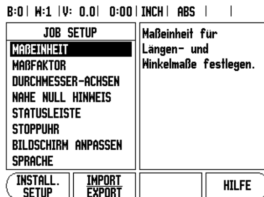
Abb. I.3 Menü JOB SETUP für die Anwendung Fräsen
